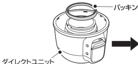
上下の方向を確認し、ダイレクトユニットに正しく取り付けてください。
